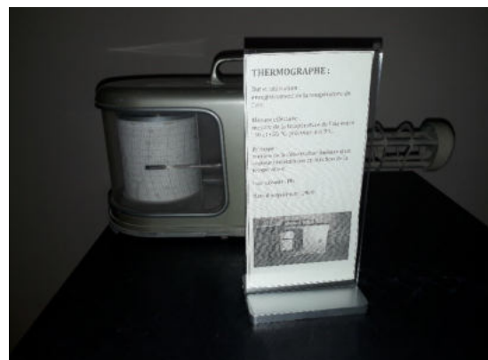
Mesure et enregistre la température de l'air sous abri
